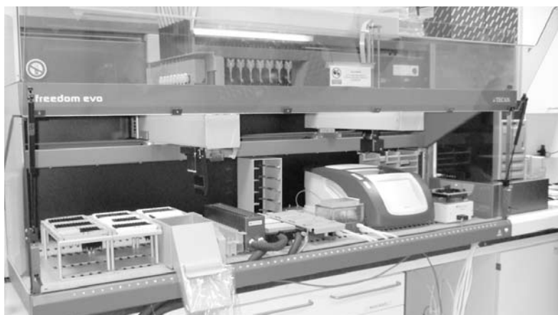
Système de manipulation de liquides Freedom EVO 200 de Tecan au laboratoire HiTEL de l'Université de York.
